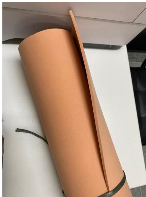
Figura 3 – EVA utilizado na confecção da palmilha
