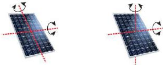
Figura 3 – Rastreadores de Inclinação de Ponta e de Azimute-Altitude e seus eixos de rotação
