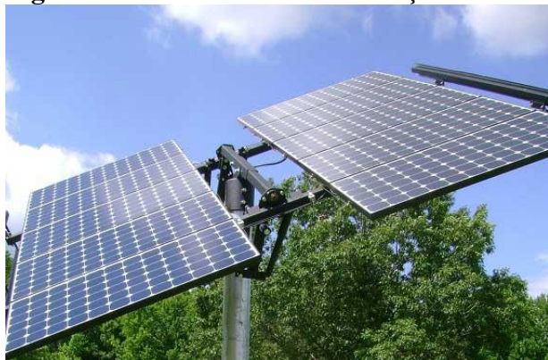
Figura 4 – Rastreadores de Inclinação de Ponta
