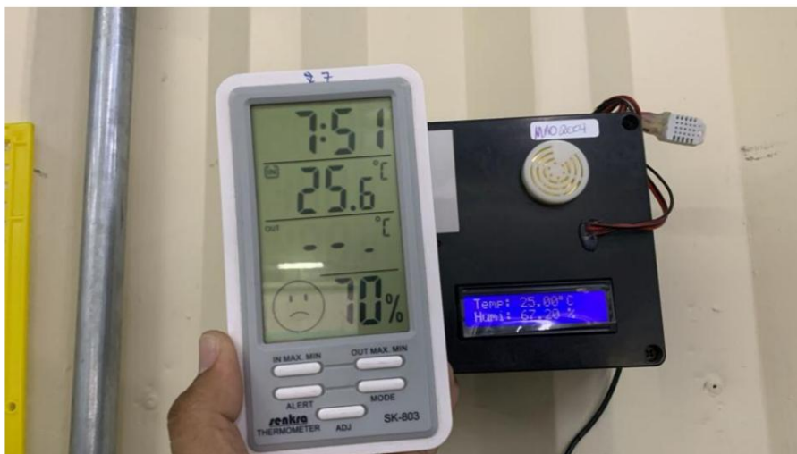
Figura 7 – Comparación entre el sensor desarrollado y el comercial.
