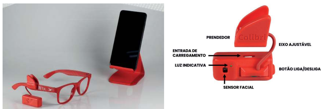
Figura 1 – Tecnologia assistiva: mouse de cabeça. Fonte: Tix Tecnologia Assistiva, s.d.
